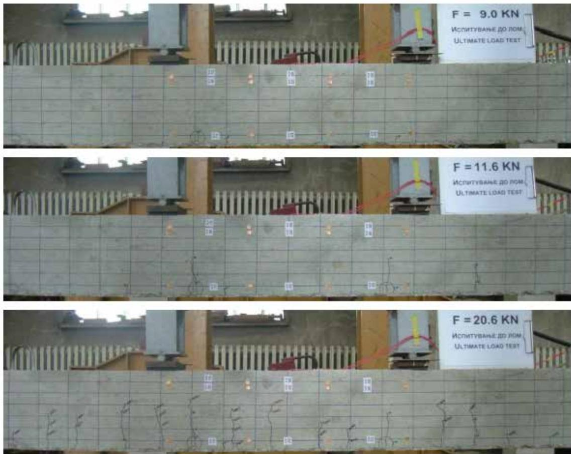
Slika 4. Razvoj pukotina karakteristične armirano-betonske grede sa čeličnim vlaknima
