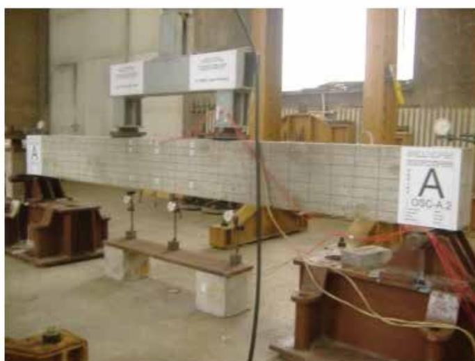
Slika 2. Prikaz grede prije ispitivanja s mjernim uređajima i nanošenje opterećenja
