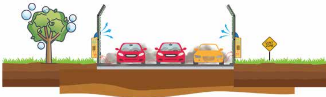
Slika 2. Kroz CIRCLEAR projekt razvit će se proizvod kojim će se osim zaštite od buke istovremeno osiguravati i pročišćavanje zraka od ispušnih plinova cestovnih vozila osiguravajući time čišći i tiši okoliš
