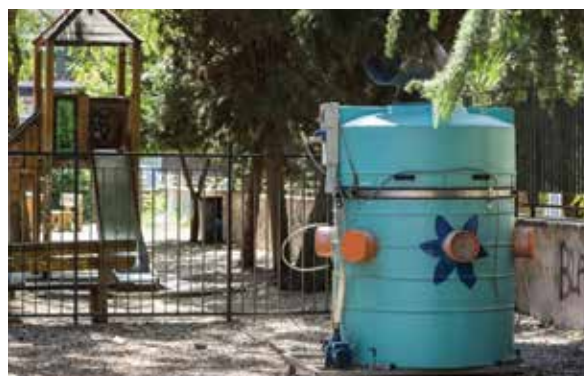
Slika 4. APA sustav razvijen za komercijalnu primjenu za pročišćenje zraka u unutarnjim i vanjskim prostorima
