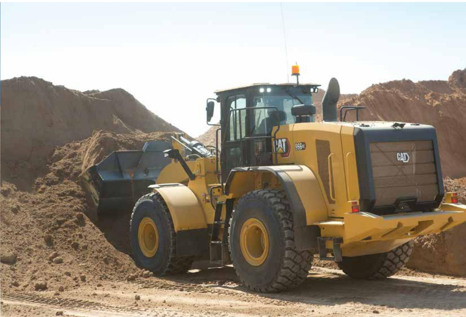
livenim poprečnim nosačem i polugom za nagib, pruža snažne mogućnosti kopanja i velike sile lomljenja kada je novi utovarivač opremljen kašikama Cat Performance serije. Hidraulički sistem priključka koji osjetljiv na opterećenje kontinuirano kontrolira protok i pritisak kako bi precizno odgovarao operativnim zahtjevima, smanjujući i opterećenje pumpe i ukupno sagorijevanje goriva.
