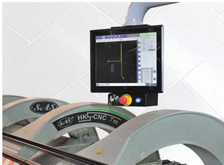
Strojevi za savijanje HKS-CNC Profi, HKS-Cs Profi, HKS E Profi i HKS-Pf Profi mogu povećati maksimalnu debljinu savijanja za aluminij ili do 2 mm za čelik povećavajući konstrukciju i hidrauličku snagu.
