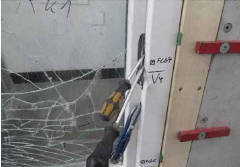
Nakon toga slijedi dinamički test; ispušta se teg od 50 kg s visine i pokušava se razbiti staklo. Postupak se ponavlja 7 puta - jednom na svakom uglu i 3 puta u sredini.
