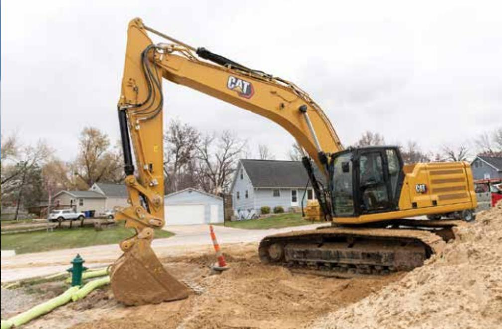
pariraju snazi bagera prema zahtjevima rada pri tome štedeći gorivo. Modus 'Snažno' daje makimalnu snagu da se zvrše najzahtjevniji zadaci; modus 'pametno' automatski prilagođava motor i hidrauličnu snagu manjоj potrošnji goriva. Smanjenjem brzine motora na konstantnih 1500 rpm 'Eko' modus minimizira potrošnju goriva. Ulje motora i filteri goriva su sinhronizovani za servis na 1.000 sati, povećavajući period rada i smanjujući troškove dijelova i rada u poređenju sa bagerima serije 336F.
