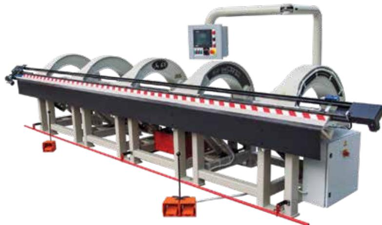
**programa**, stroj zadovoljava zahtjeve limarskih proizvođača. Radna dubina **Normal** stroja iznosi **1.050 mm**, maksimalna debljina lima kod savijanja s HKS-Pf je 0,8 mm (čelik) i 1,0 mm (Al). Strojevi se preko hidrauličke pumpe pokreću elektro motorom, koji pomoći frekvencijske regulacije omogućuje bolju dinamiku savijanja.
