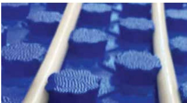
**TERRATERMAL STAR** su ploče namijenjene za ugradnju u prostore sa ograničenom i normalnom visinom, te većim tlačnim opterećenjem. Poseban oblik ivica omogućava čvrsto povezivanje ploča i laganu ugradnju. Na ploči se nalaze čepovi koji omogućavaju ugradnju cijevi promjera 14 -16mm u razmaku najmanje 50 mm. Poseban oblik rubova omogućava čvrsto povezivanje ploča i laganu ugradnju.
