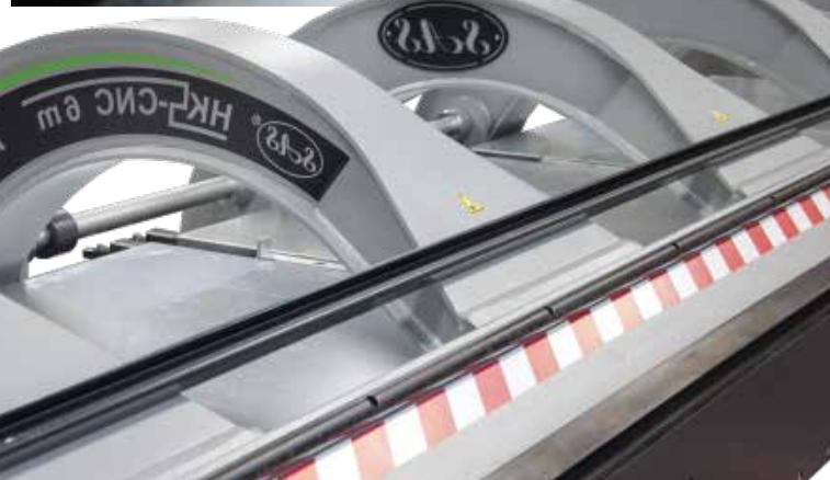
Strojevi za savijanje HKS-CNC Profi, HKS-Cs Profi, HKS E Profi i HKS-Pf Profi mogu povećati maksimalnu debljinu savijanja za aluminij ili do 2 mm za čelik povećavajući konstrukciju i hidrauličku snagu.
